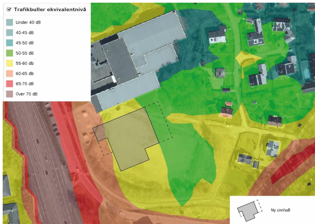
Figur 13 - Trafikbuller ekvivalentnivå - befintlig situation, utdrag ur GOkart. Planerad simhall inkippt - effekter av dess placering redovisas inte i bullerutbredningen.
